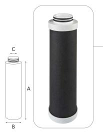
Cartucce con blocco di carbone attivo estruso "ecologico" di origine vegetale, consente la filtrazione di sedimenti fini e riduzione del sapore e odore di cloro (CTO), composti organici volatili (VOC). Con carbone argentizzato per effetto batteriostatico, filtrazione 0,3 micron.
