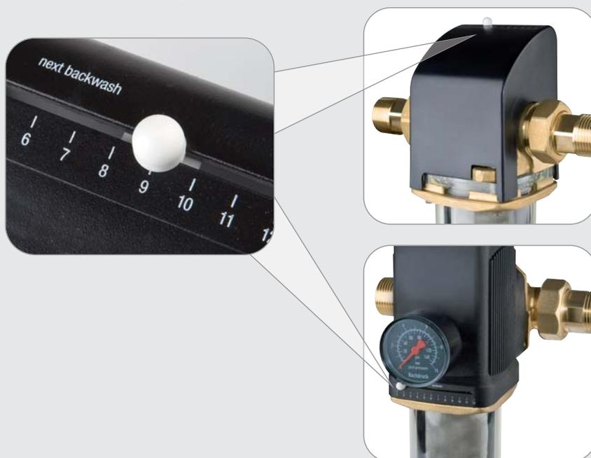
La cartuccia filtrante è in rete d'acciaio inox (AISI 304), con filtrazione nominale 100 micron. Le portate espresse nelle tabelle dei vari modelli sono riferite ad una pressione ottimale di 3 bar, con caduta di carico di 0,2 bar. I filtri HiDROFIL sono prodotti in conformità allo standard UNI EN 13443-1 (filtrazione meccanica di acqua potabile all'interno di edifici).
